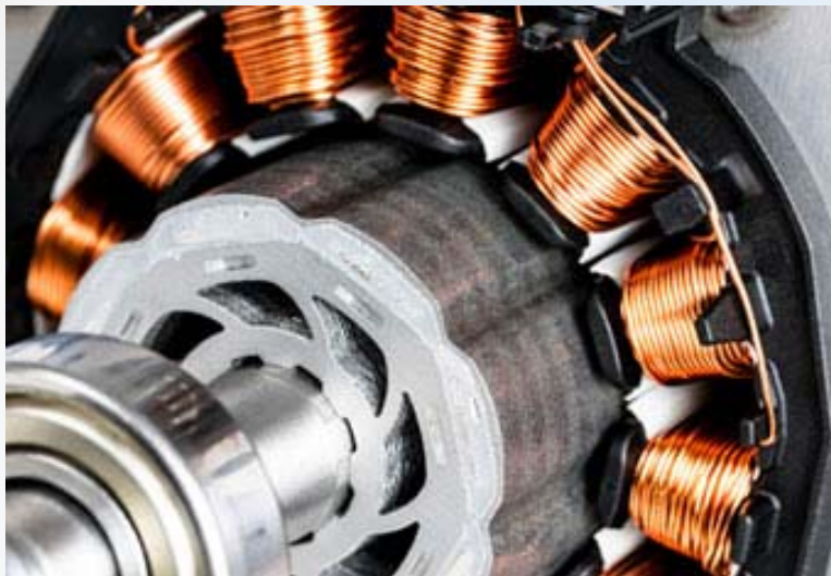
c) Înfășurare concentrată pe dinte
