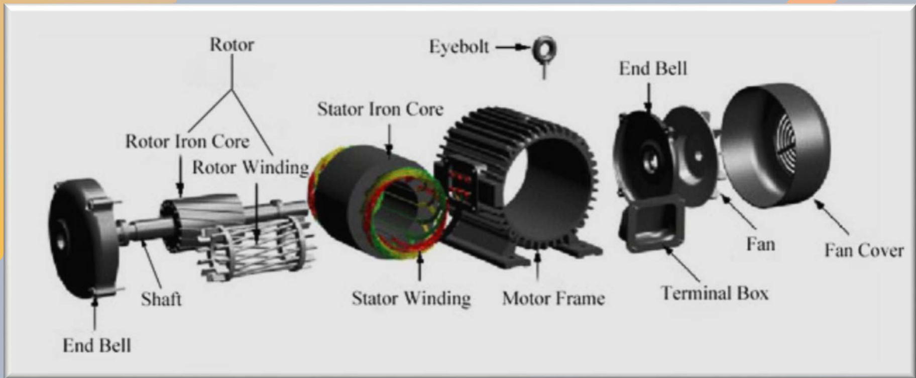
Elementele componente ale unei mașini asincrone
