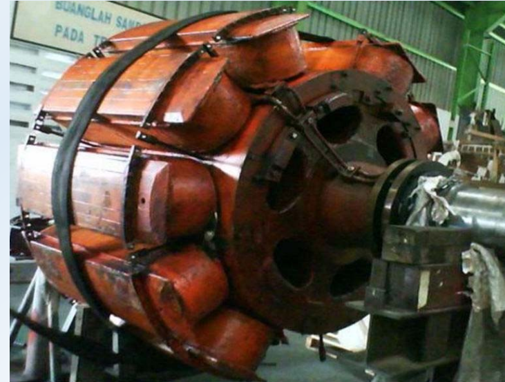
Rotor mașină sincronă cu poli aparenti
