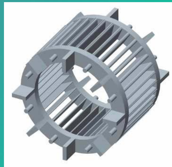
Fig. 1.13. Repartiția curenilor de aer într-un motor asincron de putere mică cu rotorul în scurtcircuit, prevăzut cu ventilator și aripioare în părțile frontale ale coliviei (turnate odată cu coliviei).
