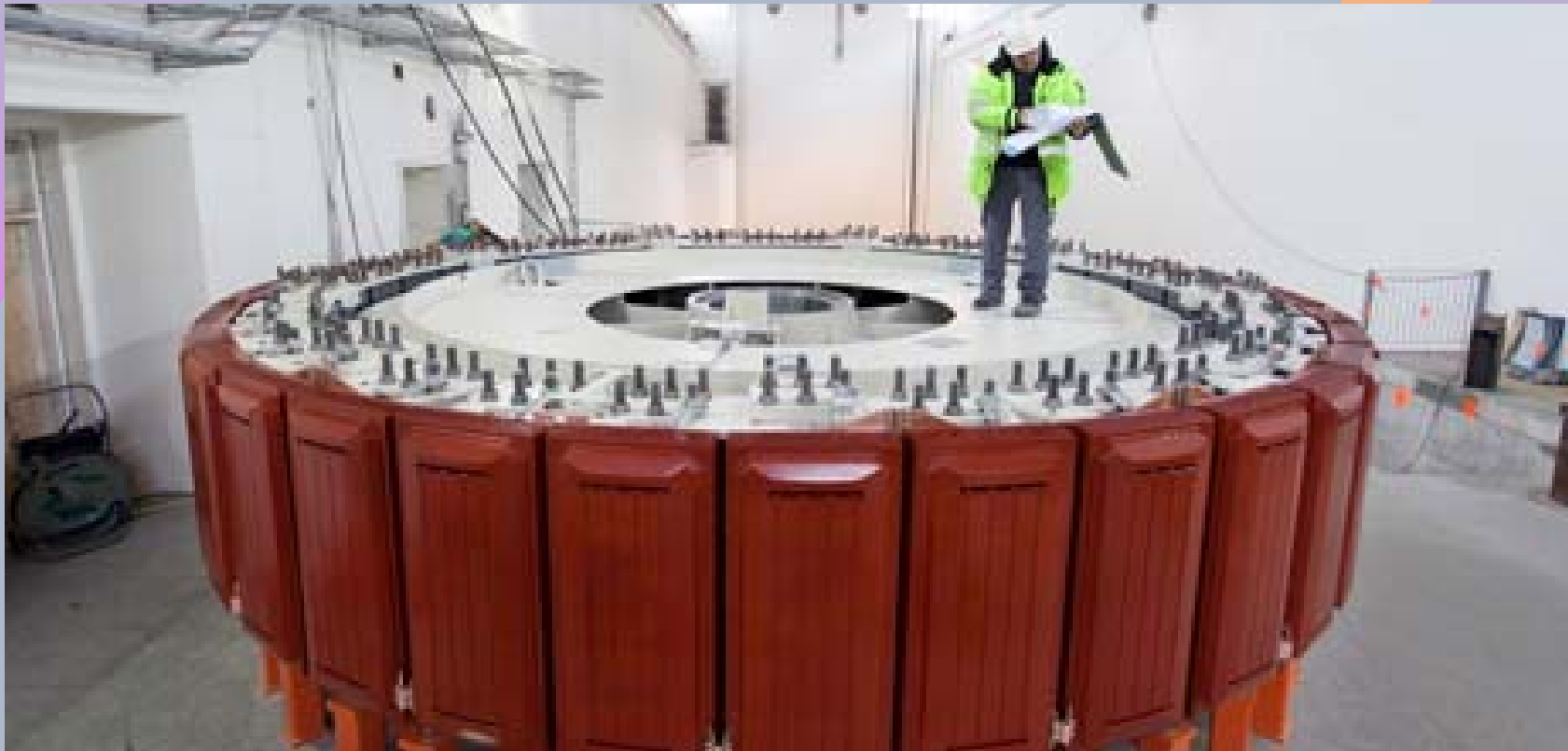
Rotor de mașină sincronă cu poli aparenti
