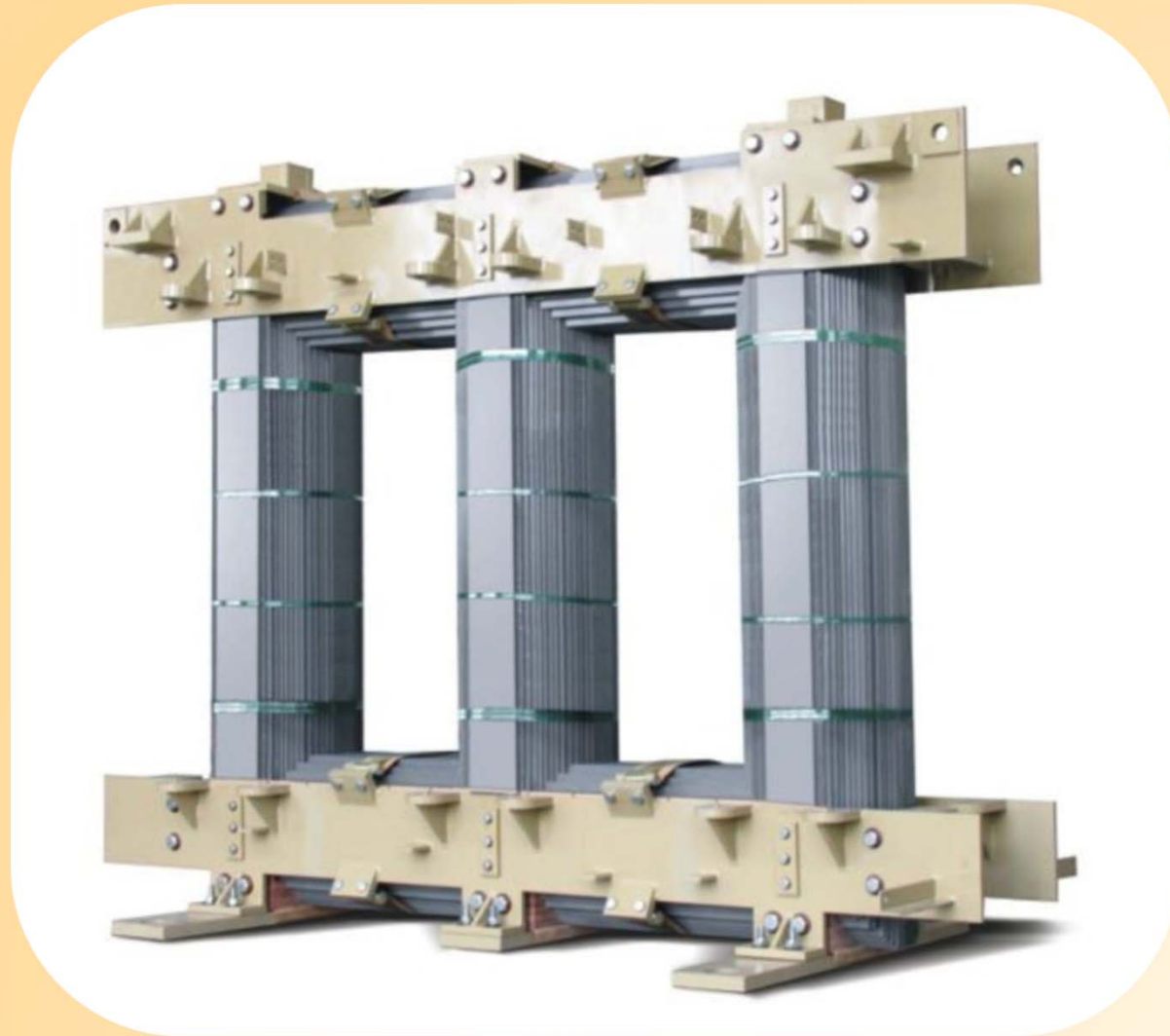
Miez de transformator trifazat de putere având coloanele realizate „in trepte”.
