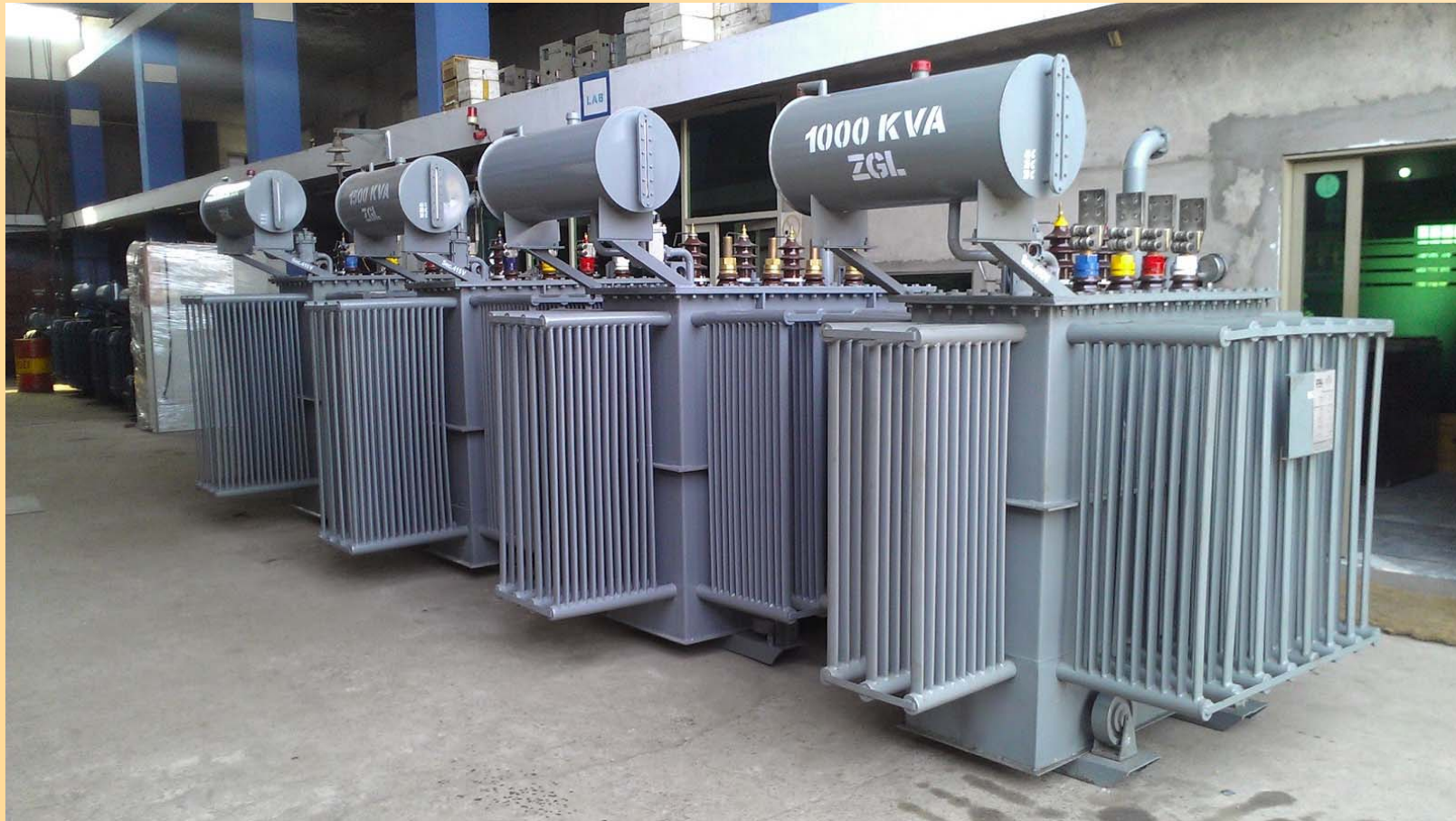
Transformatoare de putere (1000 kVA) cu ulei si răcire naturala prin țevi
