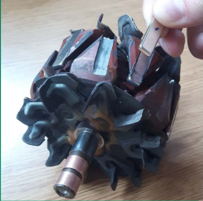
Magneți permanenți plasați pe gheare - varianta hibrida -
