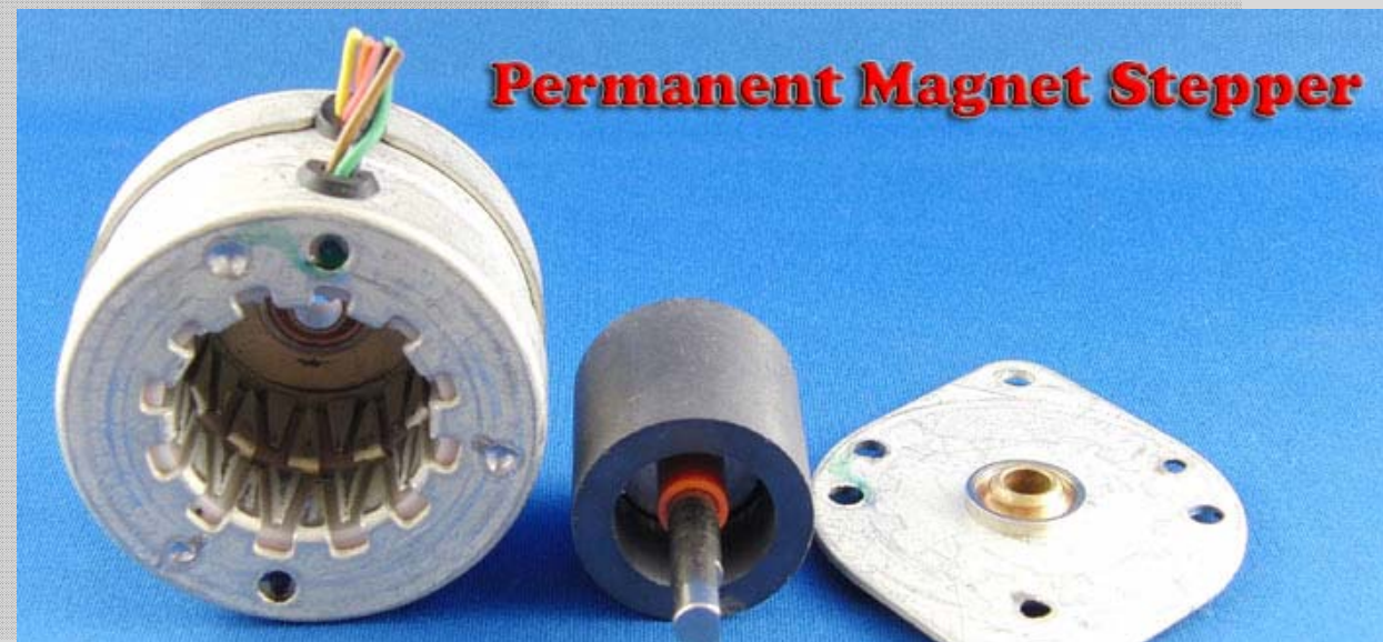
Varianta de MPP cu MP cu magnetizare radială și număr mare de poli rotorici și două miezuri magnetice statorice
