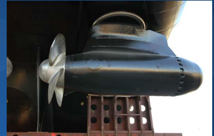
Sistem de propulsie maritima Azipod (3,3 MW)
