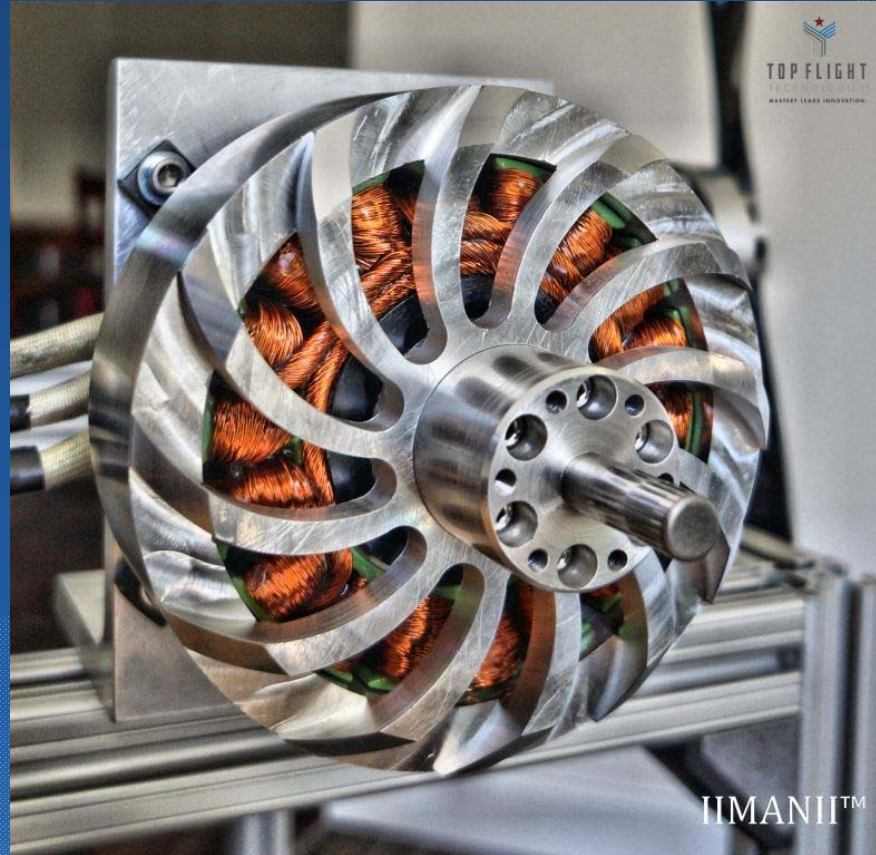
10 kW Halbach UHEHM1 Motor
